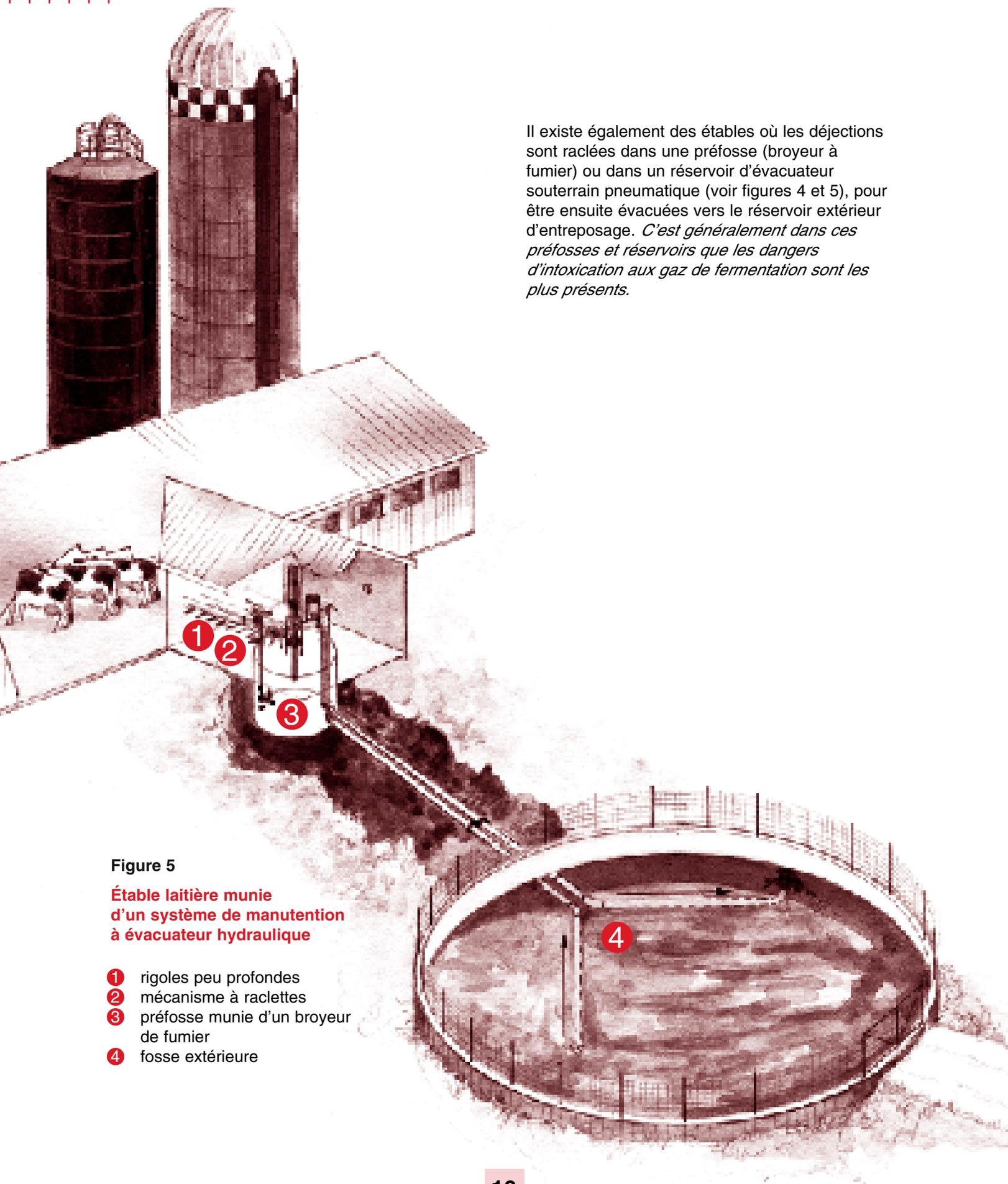
Il existe également des étables où les déjections sont raclées dans une préfosse (broyeur à fumier) ou dans un réservoir d'évacuateur souterrain pneumatique (voir figures 4 et 5), pour être ensuite évacuées vers le réservoir extérieur d'entreposage. *C'est généralement dans ces préfosses et réservoirs que les dangers d'intoxication aux gaz de fermentation sont les plus présents.*
