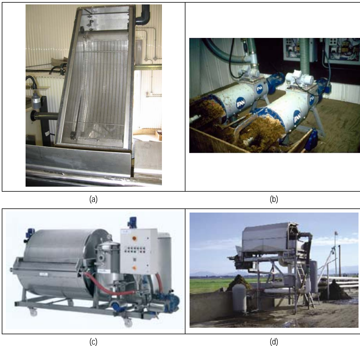
Figure 5 Quelques techniques de séparation de lisier : (a) tamis statique incliné; (b) presse à vis; (c) filtre rotatif sous vide; (d) presse à rouleaux.
