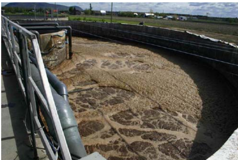
Figure 14 Réacteur d'un procédé aérobie par boues activées Biofertile-F (source : CDPO).
