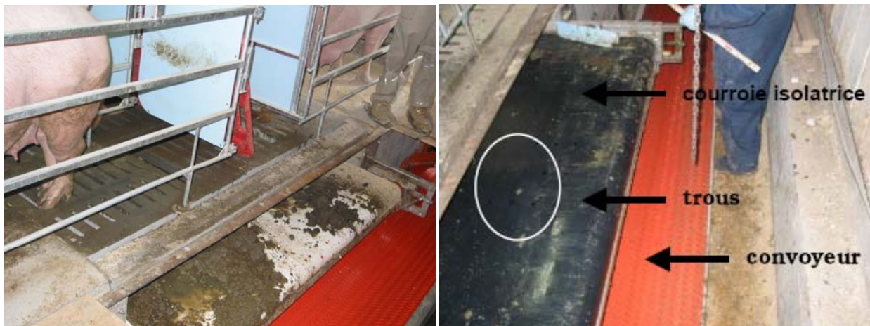
Figure 7 Isolation sous lattes avec courroie perforée.
