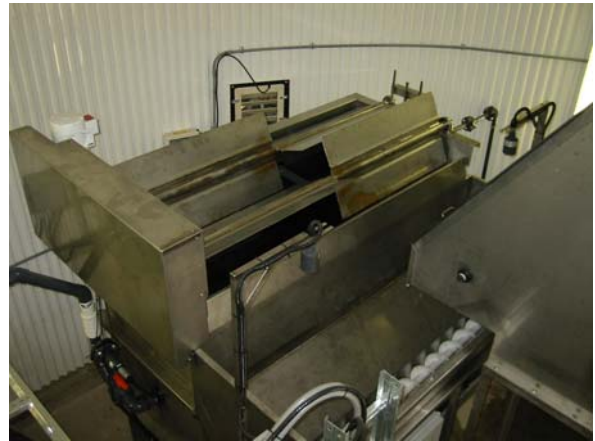
Figure 12 Vue des racleur sur le dessus du flottateur (source : Horizon Environnement Technologies).
