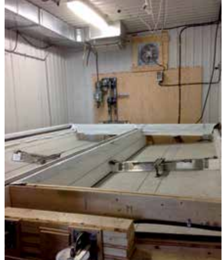
Système expérimental de grille à V de l'IRDA pour la collecte séparée du liquide et du solide des lisiers en production porcine (voir « Séparation dans le bâtiment des fractions liquide/solide » au tableau 1).
